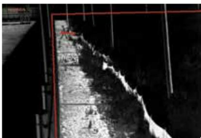
Con la termocamera Serie FC ID, è possibile impostare linee di attraversamento e regioni di interesse personalizzate per l'attivazione di allarmi solo alla rilevazione di intrusioni da parte di persone o veicoli.
